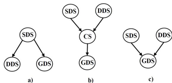
Figure 2. DMS workflows, a) Model Update, b) DMS Function Execution, c) Graphical View Refresh
